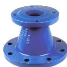
Flangereduktion. Fremstillet i duktilt støbejern. Flanger boret efter PN10.
