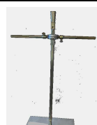
Forsynings T-nøgle m/skraldefunktion Incl. adaptore for hoved- og stikledningsventiler
