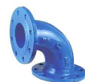
Flangebøjning 90 gr. Fremstillet i duktilt støbejern. Flanger boret efter PN10.
